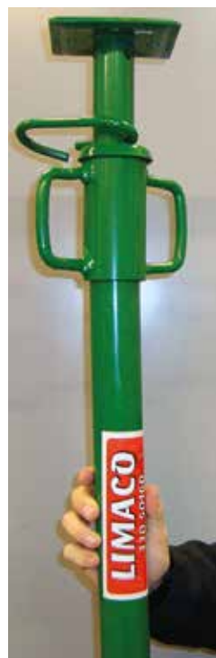
12 mm bolt (bøyle) låser støtten i ønsket høyde, og strammes med 2-hånds jusering og kraftige gjenger.
