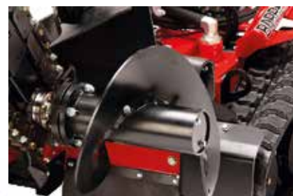
Jordskrue legger massen ut på siden
