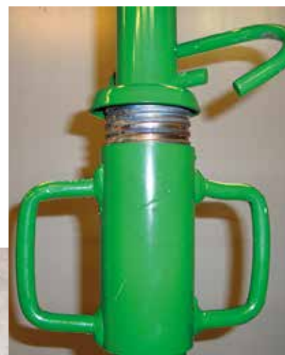
12 mm bolt (bøyle) låser støtten i ønsket høyde, og strammes med 2-hånds jusering og kraftige gjenger.
