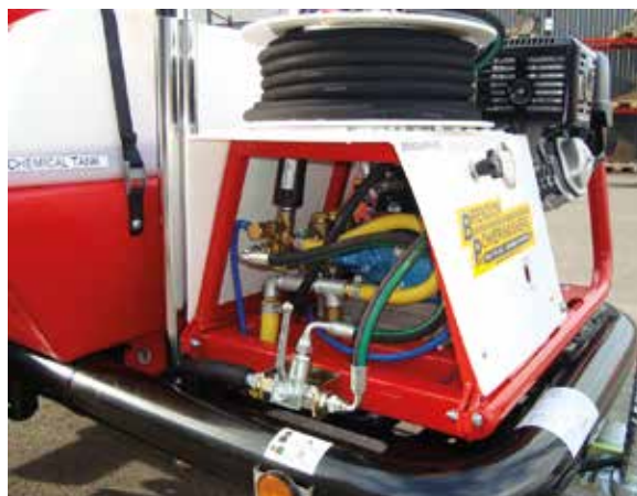
Bildet viser frontmontert slangetrommel, motor, pumpe enhet, såpe og frostsikringstank.
